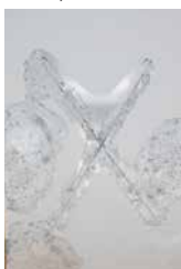
Aluminium | 1 laag poedercoating | 1008 uur ASST
